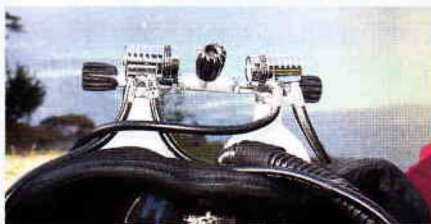
Zwei getrennte Atemreglersysteme: Redundanz ist bei Kaltwasser-Tauchgängen ein Muss.
